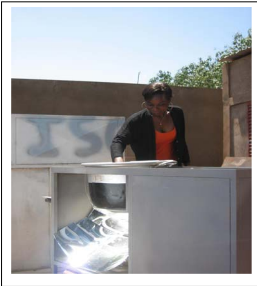
A gauche on peut bien voir le Réflecteur secondaire, ici en test (préparation de la sauce Yassa et riz). En haut, les bobines du Tracking system qui dirigent les câbles de la manivelle sont à voir.
