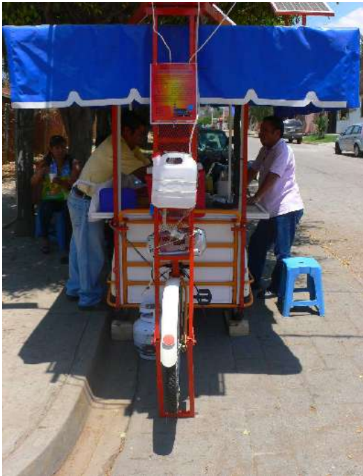
Das Dreirad mit neuem Tank und Pumpe, dem soliden Klappfuss, etc.
