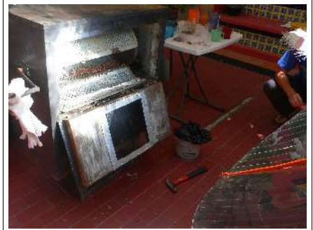
Die Tür der isolierten Kiste öffnet sich nach vorn und die Trommel kann auch geöffnet werden.
