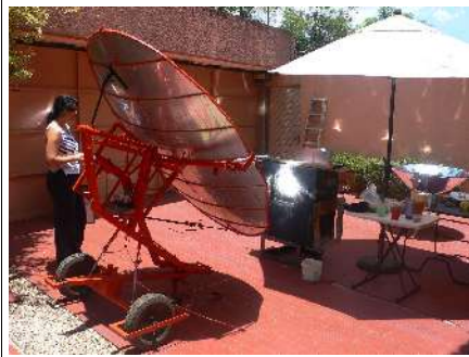
Die grosse Trommel am Fokuspunkt des Spiegels.
